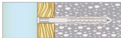
3. Montering i lettbetong/Leca
