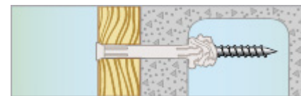
4. Montering i hulldekke- element
